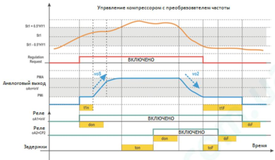
**ПРИМЕЧАНИЕ:** На преобразователь можно подавать либо частотный сигнал, либо сигнал напряжения (0-10 В пост тока), в зависимости от версии прибора.
